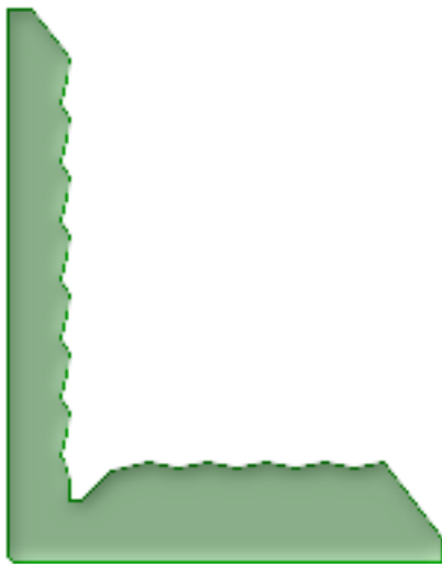
ST_ConcaveHull der als L angeordneten Punkte mit einem Zielwert von 80% der Fläche der konvexen Hülle
