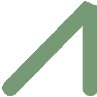
Ein Beispiel für einen Puffer; die Grafik ist direkt in PostGIS erstellt
